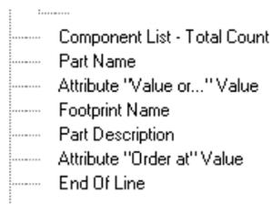
Der erste Befehl in der Auflistung berechnet die Anzahl der Bauteile pro Gruppe. Da der Zähler innerhalb der Gruppe bereits läuft kann die Anzahl mit **Component List - Total Count** ausgegeben werden.
