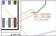
Während der Leiterbahntentflechtung zeigt die interaktive Anzeige mit einem ‚Oval‘ um den zu routenden Bereich an, ob sich die Leiterbahnlänge innerhalb der eingestellten Mindest- und Maximallängen befindet. Farb- und
