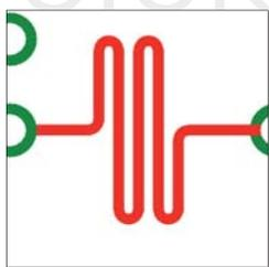
Serpentine Routing ermöglicht Ihnen High Speed Netze zu verlängern ohne Abstandsfehler zu bekommen. Man selektiert eine Leitung (oder ein Segment) und startet den Serpentine Routing Befehl. In diesem legt man Amplitude und Abstand jeder Schleife fest, die Anzahl der Schleifen und die zusätzlich benötigte Länge.
