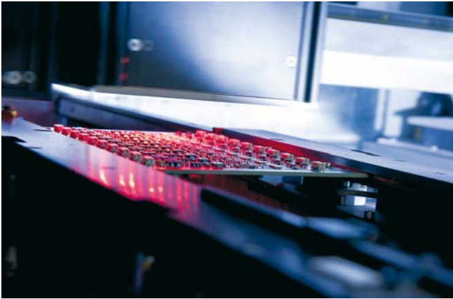
Die Automatische Optische Inspektion (AOI) – die Basis eines jeden Prüfkonzepes.
