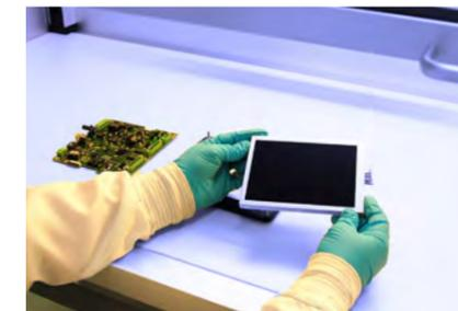
Verarbeitung elektronischer Bauteile in der Laminar Flow Box
